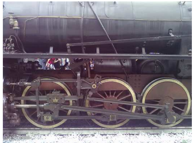
posizione di marcia avanti, l'ammissione è massima in quanto il treno sta per partire da Padova, e come detto prima è necessaria la maggior quantità di vapore.
