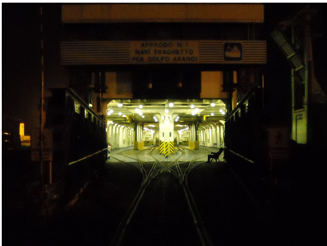
Foto in notturna degli interni della Garibaldi. Si notino la disposizione dei binari, le pareti interne e, in fondo ad ogni binario, i muletti gialli con respingenti che permettono la movimentazione dei carri all'interno della nave.
