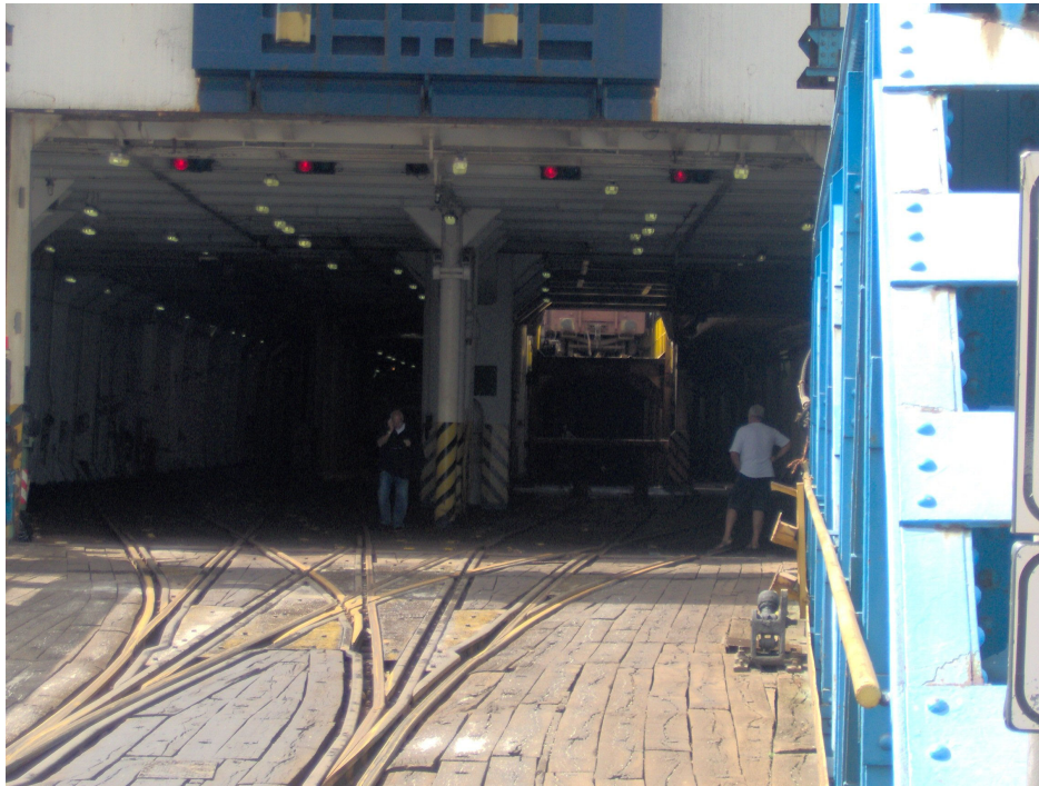
Particolare dell'ascensore: un carro è trasportato verso il ponte superiore.
